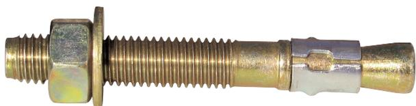
El AC es un anclaje de expansión con rosca macho y un expansor, que al acuíñarse contra el cono del cuerpo, brinda un excelente rendimiento a una gran variedad de aplicaciones de cargas semipesadas.
